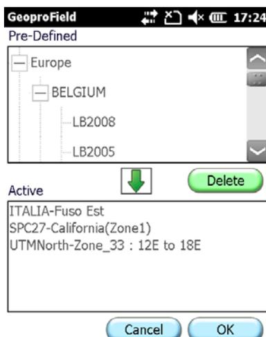
Figura 151: Sistema de coordenadas planimétricas
