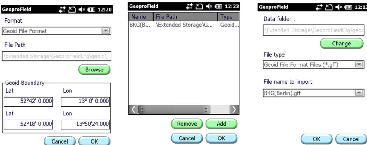
Abbildung 153: Vertikales Koordinatensystem
