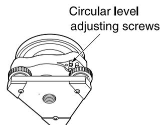
4. Ajustez les vis d'ajustement jusqu'à ce que la tension de serrage des trois vis soit identique, afin d'aligner la bulle au milieu du cercle.
