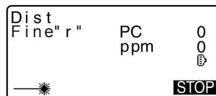
Un court signal sonore retentit et les données de mesure de distance (SD), l'angle vertical (ZA) et l'angle horizontal (HA-R) s'affichent.
