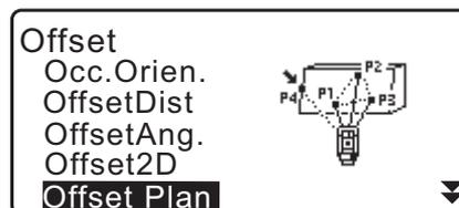
4. Faites la visée du premier point (P1) sur le plan et appuyez sur **[MEAS]** pour commencer la mesure. Les résultats de la mesure s'affichent. Appuyez sur **[YES]**.
