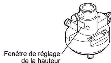
2. Mettez l'instrument de niveau et vérifiez la position de la bulle du niveau de socle.
