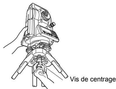
3. Tournez l'oculaire du viseur optique tout en regardant à travers afin de régler la mise au point sur le réticule.
