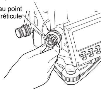
4. Ajustez les vis de mise de niveau des pieds pour centrer le point de relevé dans le réticule du viseur optique.
