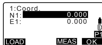
4. Saisissez l'angle azimutal et la distance à partir d'un point connu, puis appuyez sur **[OK]**. Les coordonnées du point cible s'affichent.
