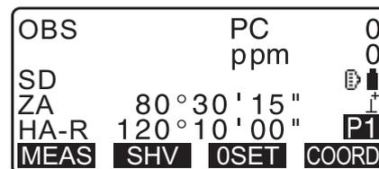
Lorsque la mesure commence, les informations de l'EDM (mode de distance, valeur de correction de la constante de prisme, facteur de correction atmosphérique) sont représentées par une lumière clignotante.
