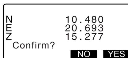
5. Faites la visée du deuxième point (P2) et du troisième point (P3) dans le plan et appuyez sur **[MEAS]**. Les résultats de la mesure s'affichent. Appuyez sur **[YES]** pour définir le plan.
