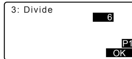
6. Les coordonnées de chaque point de division s'affichent sur les écrans consécutifs. Pour basculer entre les écrans de résultats, appuyez sur **[▶]/[◀]**. Appuyez sur **[OK]** pour revenir à l'écran dans l'étape 3 et continuer la mesure si nécessaire.
