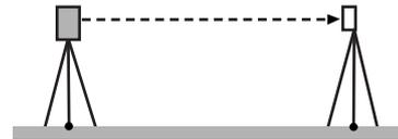
3. Lorsque l'écran du mode OBS s'affiche et que le télescope se trouve en position face 1, visiez correctement le centre de la cible et relevez l'angle horizontal A1 et l'angle vertical B1.
