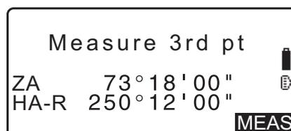
6. Faites la visée avec précision de la direction du point cible. La distance et l'angle du point cible s'affichent.
