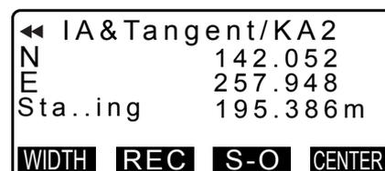
7. Dans les écrans pour le point KA1, le point KE1, le point KE2 et le point KE2 qui ont été trouvés, appuyez sur **[CENTER]** pour passer au réglages du piquet de la ligne centrale.
