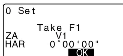
4. Visez avec précision une cible claire à une distance d'au moins 30 m dans la distance horizontale avec le télescope en position face 1.
