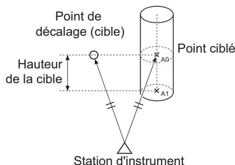
• Au cours de la collimation du point mesuré A0, l'angle vertical peut être fixé à la position du prisme ou réglé pour être déplacé selon le mouvement montant/descendant du télescope.
