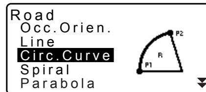
6. Appuyez sur **[OK]** dans l'écran indiqué dans l'étape 5 pour calculer les coordonnées du piquet central. Les coordonnées et l'angle azimutal sont alors affichés dans cet écran.
