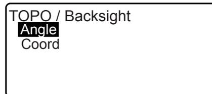
4. Inserire l'angolo azimutale.
