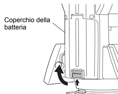
2. Controllando il lato del terminale della batteria, inserire la batteria come mostrato.
