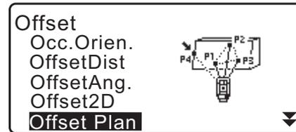
4. Traguardare il primo punto (P1) sul piano e premere **[MEAS]** per avviare la misurazione. Vengono visualizzati i risultati della misurazione. Premere **[YES]**.
