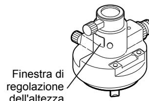
2. Livellare lo strumento e verificare la posizione della bolla della livella torica.
