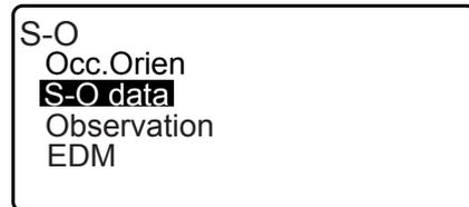
3. Selezionare "S-O data" (Dati picchettamento). Viene visualizzato <S-O Coord> (Coordinate picchettamento).
