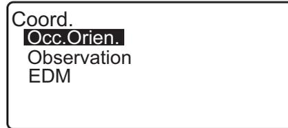
4. Em <Coord>, selecione “Observation”. Pressionar **[MEAS]** iniciará a medição e o valor de coordenada do alvo será exibido. Pressione **[STOP]** para sair da medição.
