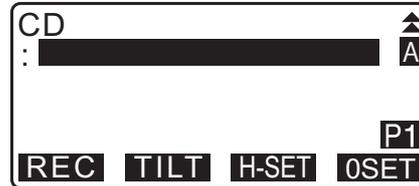
4. Verifique os dados inseridos e pressione **[REC]**.5. Para continuar a medição, mire o próximo ponto, pressione **[MEAS]** e execute as etapas 3 e 4 acima.
