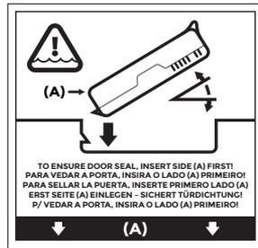
Halten Sie den Akku so, dass die schwarze Lasche an der Akku-Vorderkante nach oben und zum Klappenriegel hin zeigt (diese Lasche hilft Ihnen, den Akku zu entnehmen). Legen Sie zuerst die hintere Kante ein und drücken Sie sie dabei vorsichtig unter die beiden Akkubefestigungen. Drehen Sie die Vorderkante nach unten, bis sie in der richtigen Position ist.
