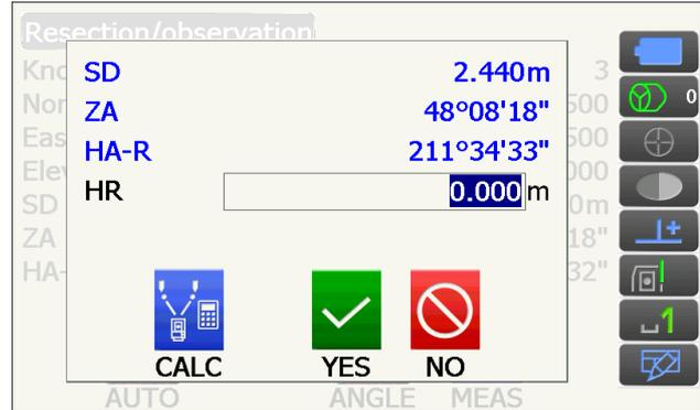
**[AUTO]** verrà visualizzato dal terzo punto in avanti. Premendo **[AUTO]** lo strumento ruoterà fino al punto successivo ed eseguirà una misurazione automatica.
