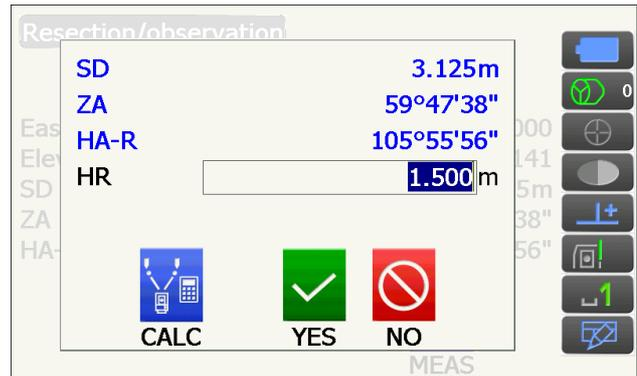
6. Premere **[CALC]** o **[YES]** per avviare automaticamente i calcoli una volta completate le osservazioni di tutti i punti noti.
