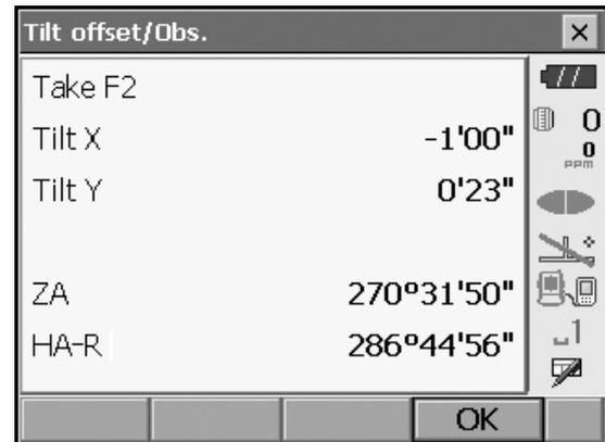
8. Pressione **[OK]** e gire a parte superior do instrumento e o telescópio em 180 graus.
